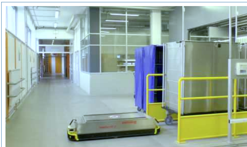
Abb. 2: Automatisches Warentransportsystem (AWT)
